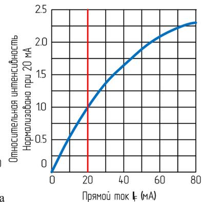
Рис. 4. Зависимость интенсивности от тока
