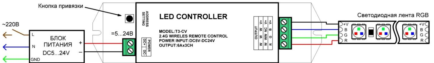
Схема 1. Подключение светодиодной ленты RGB
