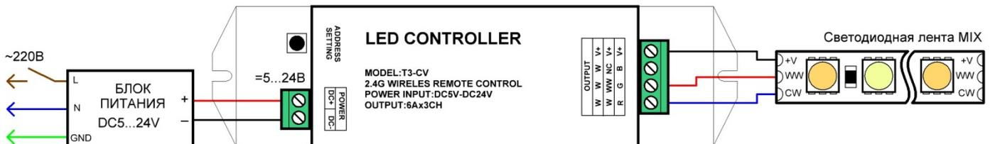
Схема 2. Подключение светодиодной ленты MIX
